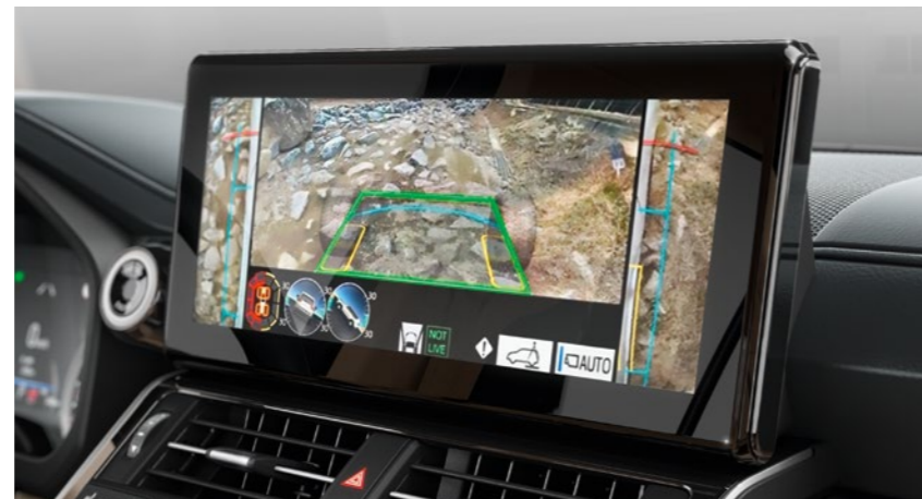
Система помощи при движении по бездорожью Multi-Terrain Monitor с 3D-режимом
